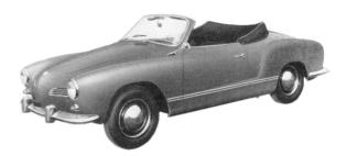
Otto-Motor · 4 Zylinder · 4-Takt · 1,19 Liter · 34 PS bei 3600 U/min
